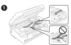
Secure print head with a tape 使用膠帶固定印 字頭
