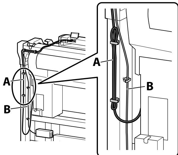
Na het aansluiten van interfacekabel (A), rol het losse deel op en klem het op zijn plaats zoals getoond.
