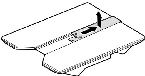
Para imprimir em polos, necessita do parafuso e da peça quadrada que foram removidos. Guarde-os num local seguro. Recomendamos que fixe o parafuso à placa de impressão para não o perder.
