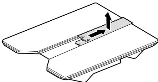
U hebt de schroef en het verwijderde vierkante deel nodig bij het afdrukken op poloshirts. Bewaar ze op een veilige plaats. We raden aan om de schroef voor veilige opslag aan de drukplaat te bevestigen.
