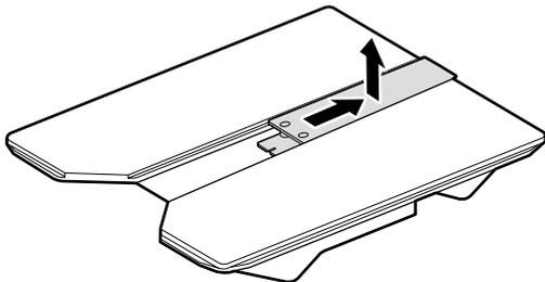
在 Polo 衫上列印時，您需要用到已移除的螺絲和方形零件。請將其妥善保存。建議將螺絲固定至印刷平壓板，以免遺失。
