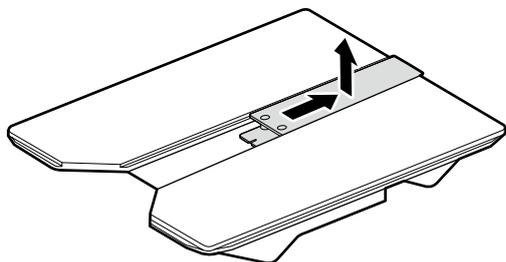
При печати на рубашках поло (тенниска) следует отвернуть винт и извлечь прямоугольную деталь. Храните их в надежное место. Для надежного хранения мы рекомендуем закрепить винт на столике.
