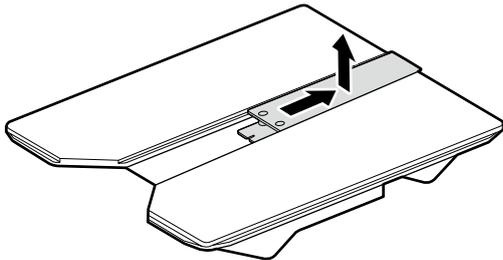
取り外したネジ、部品はポロシャツ用メディア使用時に必要です。保管してください。ネジはプラテンに取り付けての保管をお勧めします。
